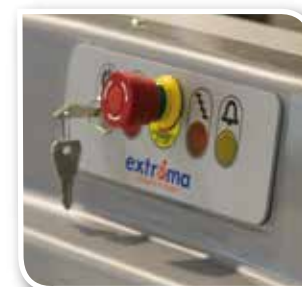
Pannello di controllo e comando a bordo macchina.
